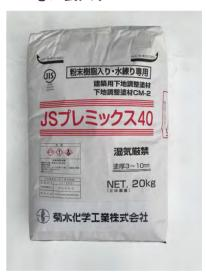
施工上の注意●現場で水以外は混入しないで下さい。 ●清水には、水道水を使用して下さい。 ●塗り付け施工からモルタルが硬化するまで気 温5℃以上を維持し、凍結防止の為に適切な養生を行って下さい。 ●直射日光の当たる所、通風の激しい場所での施工ではシート等で養生を行っ ●練り混ぜた材料は、1時間以内に使用して下さい。 ●直射日光下及び3℃以下での保管は避けて下さい。 ●湿気や雨掛かりに 注意して保管して下さい。 安全上の注意 ●取り扱う際は、保護メガネ・保護手袋等の保護具を着用して下さい。 ●取り扱い後は、顔・手・ 口等を洗浄して下さい。 ●材料が目に入った場合はただちに水洗いをしてすみやかに医師の診断を受けて下さい。 ●セメントのアルカリ分が 皮膚の炎症をおこすおそれがありますので、かゆみや炎症等の症状のある場合は、すみやかに医師の診断を受けて下さい。 ●飲み込んだ場合は、 直ちに吐かせ医師の診断を受けて下さい。 ●漏出した製品が河川・下水道へ流入すると環境を汚染するおそれがありますので充分注意して下さい。
