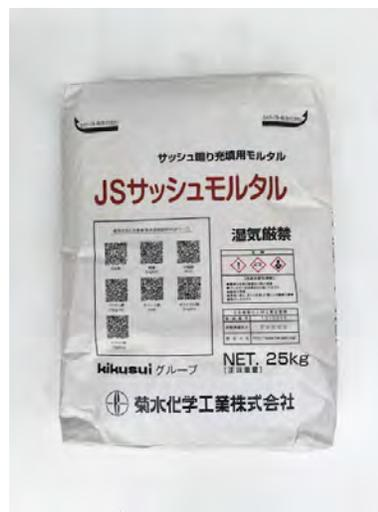
**施工上の注意** ●現場で水以外は混入しないで下さい。 ●清水には、水道水を使用して下さい。 ●塗り付け施工からモルタルが硬化するまで気温5℃以上を維持し、凍結防止の為に適切な養生を行って下さい。 ●直射日光の当たる所、通風の激しい場所での施工ではシート等で養生を行って下さい。 ●練り混ぜた材料は、1時間以内に使用して下さい。 ●直射日光下及び3℃以下での保管は避けて下さい。 ●湿気や雨掛かりに注意して保管して下さい。 **安全上の注意** ●取り扱い際は、保護メガネ・保護手袋等の保護具を着用して下さい。 ●取り扱い後は、顔・手・口等を洗浄して下さい。 ●材料が目に入った場合はただちに水洗いをしてすみやかに医師の診断を受けて下さい。 ●セメントのアルカリ分が皮膚の炎症をおこすおそれがありますので、かゆみや炎症等の症状のある場合は、すみやかに医師の診断を受けて下さい。 ●飲み込んだ場合は、直ちに吐かせ医師の診断を受けて下さい。 ●漏出した製品が河川・下水道へ流入すると環境を汚染するおそれがありますので充分注意して下さい。
