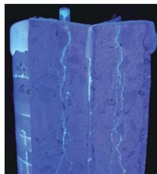
切断面紫外線照射
