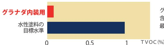
グラナダ内装用は、総揮発性有機化合物（TVOC）の含有量が0.1%以下。室内塗料のVOCの分類では最高ランクのW1に該当します。
