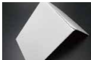
【他社無機複合塗料】ひび割れ発生
