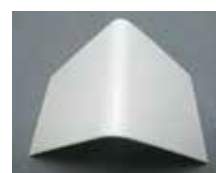
キクスイ SPパワー無機ガードF を塗装した試験体を曲げててもひび割れを起こしません。
