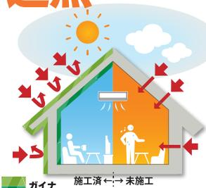
GAINAの特殊セラミックは太陽光に含まれる赤外線を反射。また、塗装面が周辺の温度に適応し、熱の移動を最小限に抑えます。この効果で冷房効率も高まり省エネにも貢献します。
