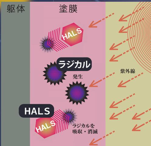
紫外線により発生したラジカル(劣化要因)をHALS(光安定剤)が吸収・消滅。
