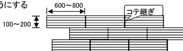
ii) ノコ目付けは、横方向とし、且、不連続だが継ぎ目を目立たなくし、横方向には連続のイメージで仕上げる方法。継ぎ部分が目立たないように丁寧にコテを運ぶ。
